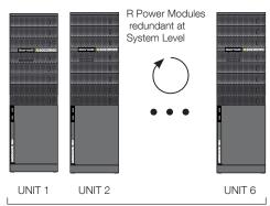
SYSTEM WITH DISTRIBUTED POWER MODULE REDUNDANCY
