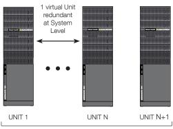
SYSTEM WITH DISTRBUTED UNIT REDUNDANCY
